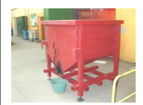
Silo à granulés
